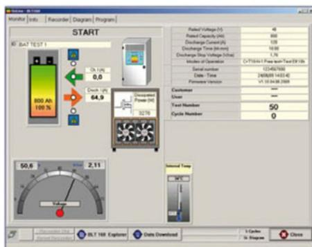
Экран отображения параметров работы в реальном времени: уровень заряда и напряжение АКБ, установленные параметры цикла разряда, температура BLT.
